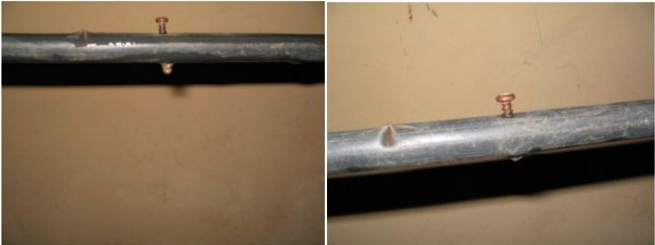
Figura 6. Posición final del tornillo gotero
