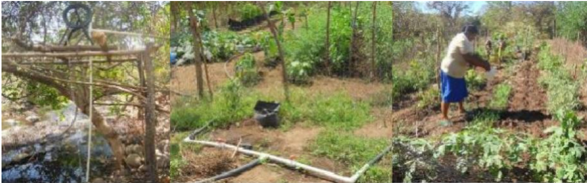
1. Bomba de mecate aérea en una poza del río. 2. Tubería de conducción de poliducto de 1" de unos 150 m de largo, hasta entrada de las parcelas. 3. La señora Concepción Pérez regando los cultivos de su parcela mediante este sistema.
