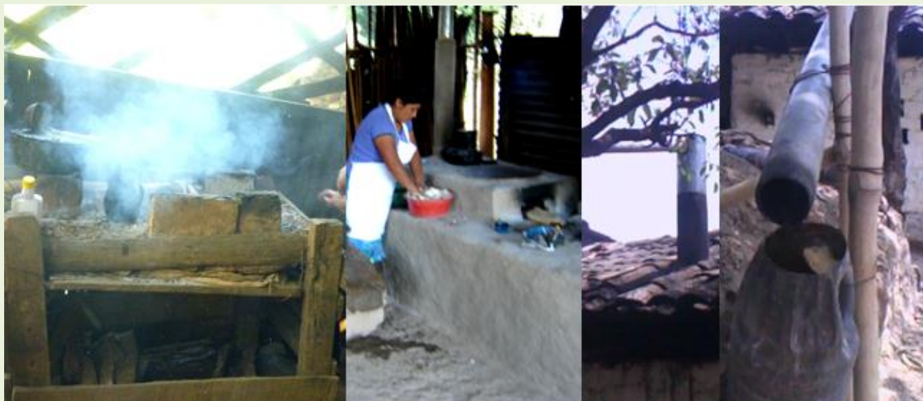
1. Cocina tradicional, 2. Cocina ahorradora de leña con su chimenea, 3. Adapta del tubo galvanizado a la chimenea “sellada” en su parte superior, 4. Colecta del humo en forma líquida
