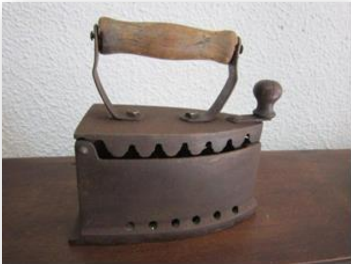
Figura 32. Plancha hecha de hierro fundido y con maneral aislante
