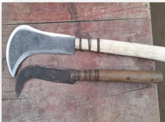
Figura 48. Cuma con doble filo y su desgaste por el uso
