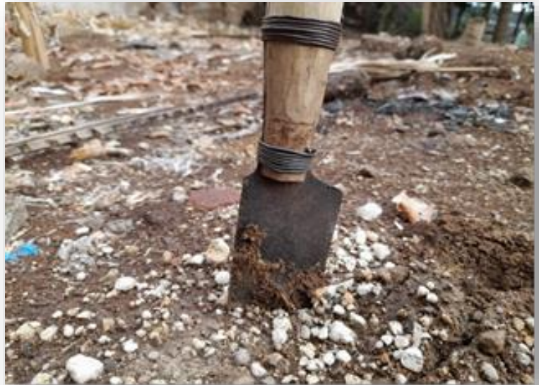
Figura 51. Chuzo elaborado con la punta de una cuma usada
