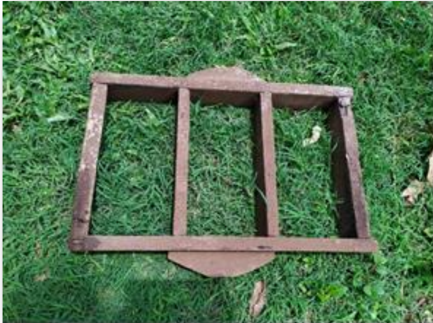
Figura 20. Gradilla de madera con tres secciones, usada para elaborar ladrillos de barro
